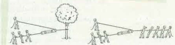
10 | Übersicht der Seilführung durch einen Flaschenzug mit vier Rollen in zwei Flaschen und die beiden zusätzlichen Seilstücke, einmal befestigt an der „festen“ Flasche, die in Position bleibt, und einmal an der „losen“ Flasche, die sich bei Benutzung des Flaschenzugs bewegt
