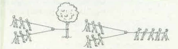
9 | Tauziehen über eine einfache Rolle, was „Winkelfreiheit“ verschafft, links mit Befestigung der Rolle, rechts mit einer dritten Gruppe, die die Rolle in Position hält
